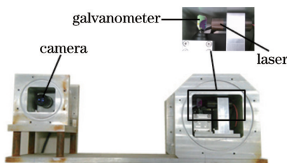
图6 结构光自扫描测量装置
