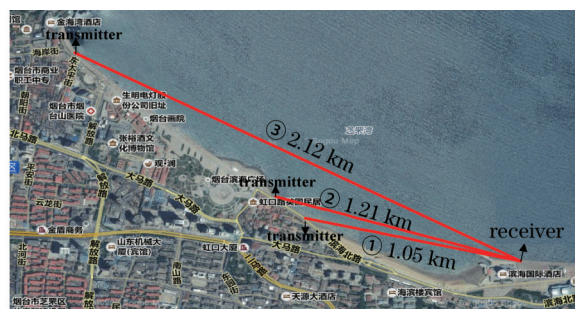
图2 近海面准直光束漂移测试链路航拍图(数据来源于 Sogou maps.com)
