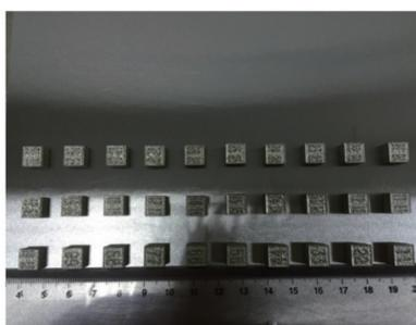
图 3 不同工艺参数选区激光熔化成形 Ni 块体
