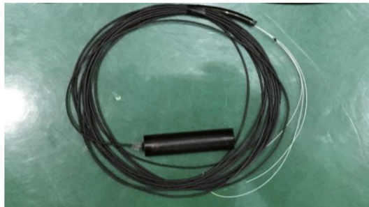
图 7 新型光路的光纤水听器
