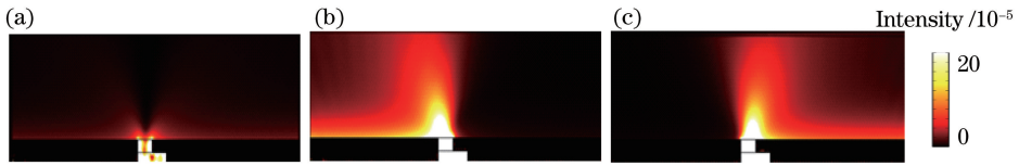
图 5 不同入射角度下的能流密度分布图。(a) -\pi/3 ; (b) -\pi/12 ; (c) \pi/6
