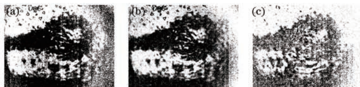
图 11 装在信封中的隐藏物钥匙的斯托克斯参量(a) I 、(b) Q 和(c) U 的 THz 图像
