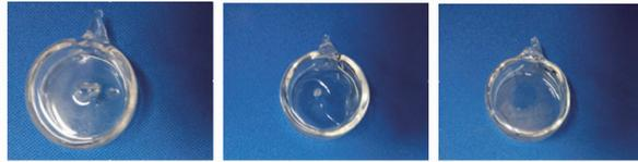
图3 实验结果。(a)  $2.67 \times 10^4$  Pa 甲烷,  $5.33 \times 10^4$  Pa 氦气; (b)  $6.67 \times 10^4$  Pa 甲烷,  $7.33 \times 10^4$  Pa 氦气; (c)  $6.67 \times 10^4$  Pa 甲烷,  $7.33 \times 10^4$  Pa 氦气, 占空比 1:1
