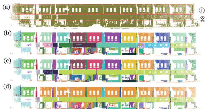
图5 面片合并示意图:(a) 原始点云;(b) 初始分割点云;(c) r_d=0.5 m;(d) r_d=1 m
