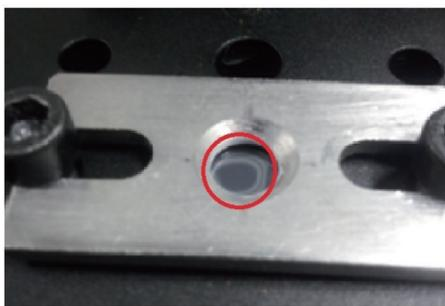
图 1 夹装后试样中的暗区
