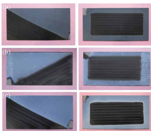
图3 激光辐照制备 (a) PTFE、(b) PEP、(c) PFA 图形化膜涂层
