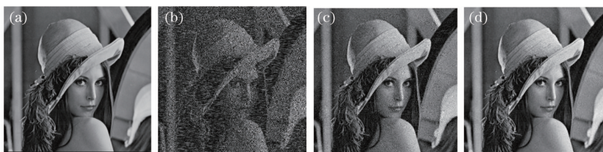
图6 Lena加密图像 I(u,v) 的 COA 攻击结果。(a) 原始图像; (b) M_{MSE}=0.05 时的攻击恢复图像; (c) M_{MSE}=0.005 时的攻击恢复图像; (d) M_{MSE}=0.0005 时的攻击恢复图像
