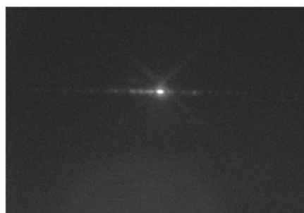
图5 热光开关器件的输出光斑
