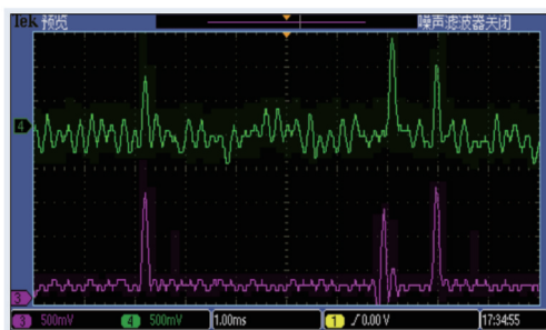
图 8 白细胞的前向光散射信号 Fig.8 Forward light scattering signal
