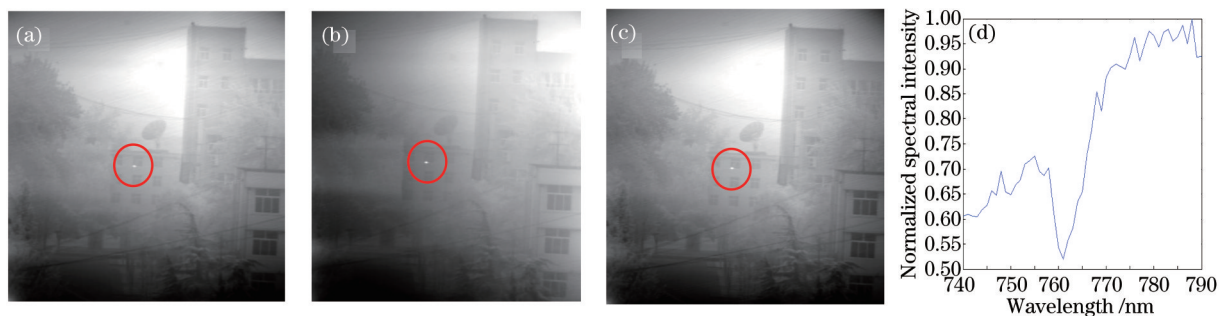
图2 雾霾天气。(a) 750 nm 波段场景图; (b) 762 nm 波段场景图; (c) 780 nm 波段场景图; (d) 目标归一化光谱分布图
