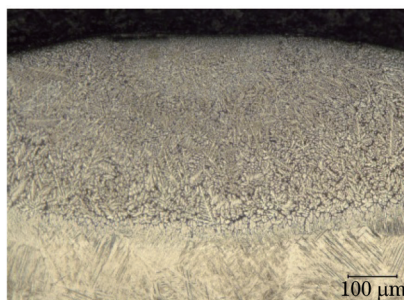
图 2 生物陶瓷复合涂层截面形态
