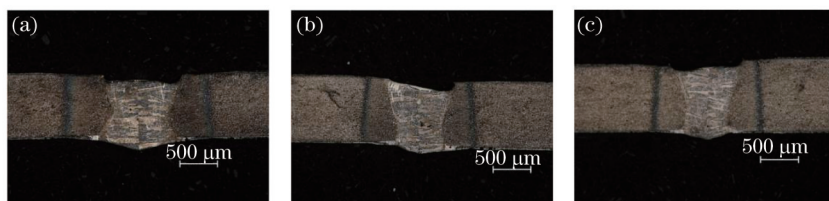
图5 焊缝横截面金相( \times 50 )。 (a) 1#, P=2 kW, v=3 m/min; (b) 2#, P=2 kW, v=4 m/min; (c) 3#, P=2 kW, v=5 m/min
