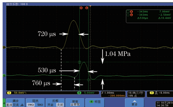
图 4 720 μs 脉宽的钬激光脉冲(通道 1)水下诱导振荡波信号(通道 4)形貌
