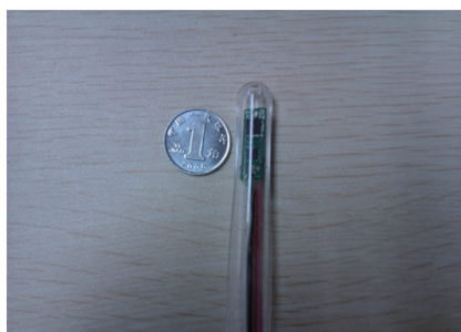
图1 用于手术导航的微机电惯性传感单元
