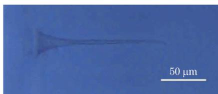
图 11  $400\ \text{nm}$  波长激光加工微孔形貌
