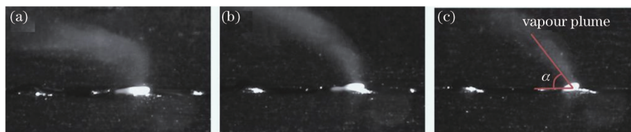
图10 不同扫描速度下熔池金属蒸气的喷射角度。(a) 16 m/min; (b) 20 m/min; (c) 24 m/min
