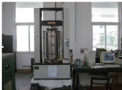
图2 热拉伸试验设备
