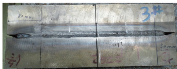
图 4 焊接接头的表面成形
