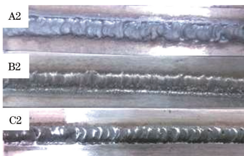
图 1 不同成分配比复合涂层的表面宏观形貌 Fig.1 Macro surface morphology of composite coatings in different component proportions
