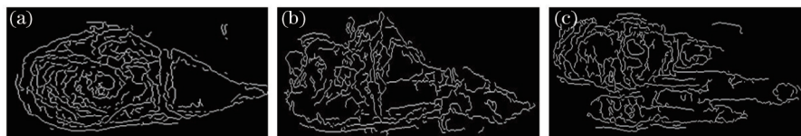
图9 位置1、2、3处小波变换损伤提取结果
