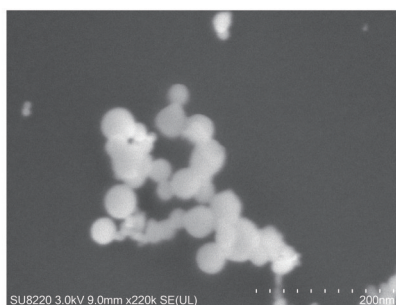
图 3 30 mJ 脉冲激光辐照黄色漆板所收集的纳米网状结构的形貌
