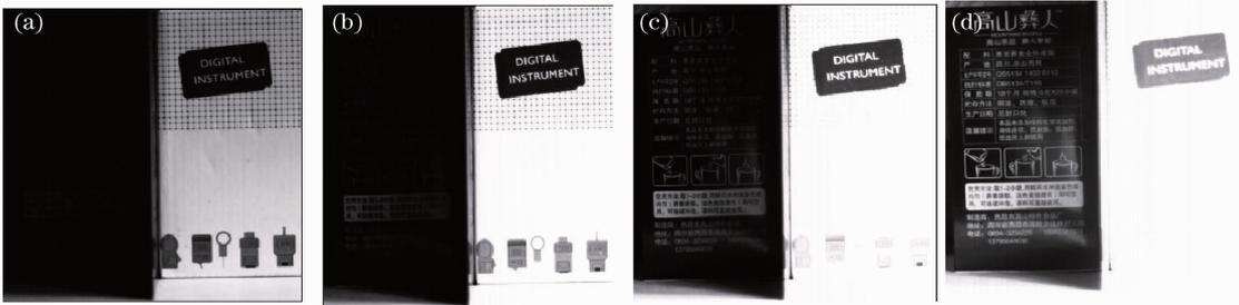
图 7 (a)、(b)、(c)、(d) 分别对应积分时间为  $T_0$ 、 $2T_0$ 、 $4T_0$ 、 $8T_0$  时的图像序列
