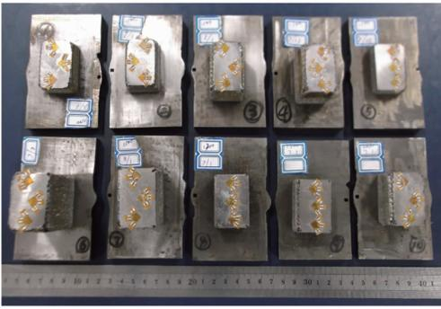
图 3 激光增材制造样件
