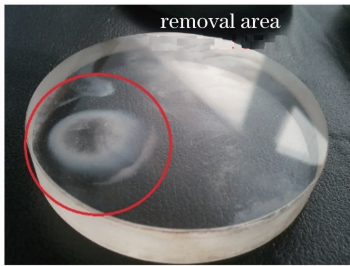
图 3 使用 PCET 来加工熔石英的结果 Fig. 3 Fabrication result of PCET on fused silica
