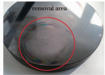
图 6 使用 PCET 来加工碳化硅材料的结果 Fig. 6 Fabrication result of PCET on RB-SiC
