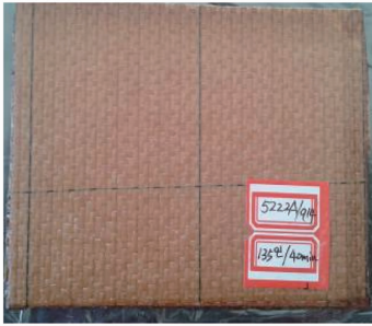
图 7 真空袋工艺制备的碳/双马树脂复合材料
