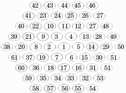
图 2 变形镜驱动器位置排布图
