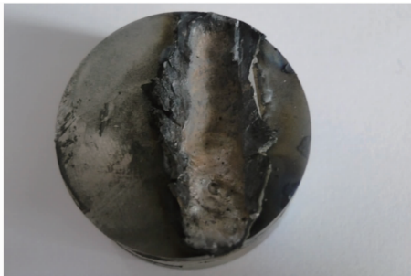
图 2 预置层厚度为 0.8 mm 的熔覆层宏观形貌
