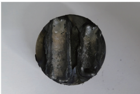
图 11 激光功率 4 kW、扫描速度 4 mm/s 时涂层的宏观形貌
