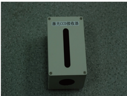
图 2 CCD 激光接收器
