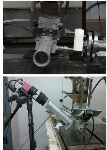
图 2 局部负压激光焊设备
