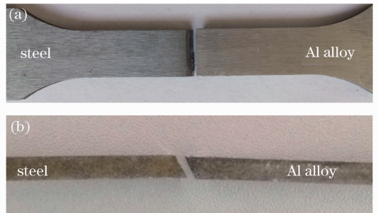
图 10 断裂拉伸试样的宏观形态。(a) 上表面; (b) 侧面 Fig. 10 Macro form of a broken tensile sample.
