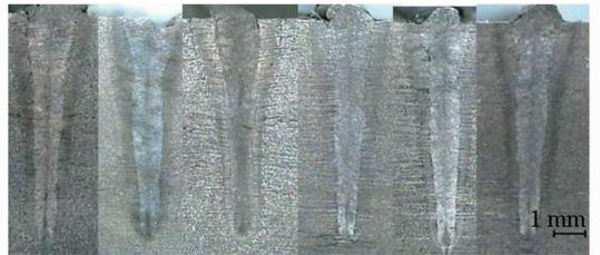
图8 当横向气帘在5 mm高度处时焊缝横截面的形态
