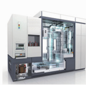
图 15 干涉仪波长跟踪器在 90 nm 光刻机中的应用
