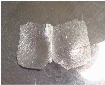
图 7 钼带 LSF 试样的完全层裂宏观形貌
