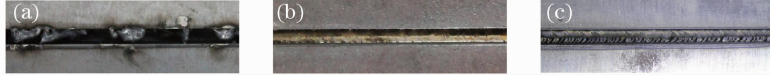
图 7 加热电流对窄间隙焊缝成型的影响。(a) 120 A, 熔断过渡; (b) 90 A, 连续过渡; (c) 40 A, 顶丝过渡
