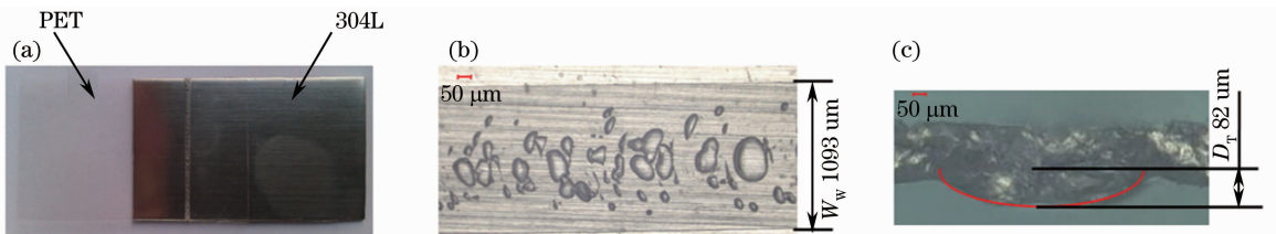
图 8 (a) 实验试样宏观形貌; (b) 焊缝微观形貌; (c) 熔池微观形貌
