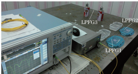
图 9 基于 WDM 的光化学三参量传感实验系统 Fig. 9 Experimental system for tri-parameter photochemical sensing based on WDM
