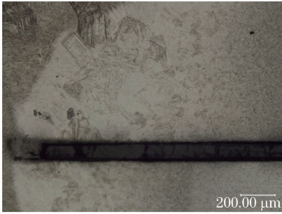
图 11 点焊脉冲后界面反应层组织的形貌
