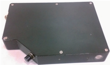
图 6 所研制的高分辨率光纤光谱仪样机
