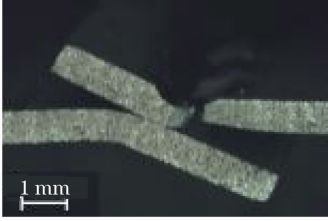
图8 凹坑造成接头强度下降(试样2,间隙0,功率3 kW)
