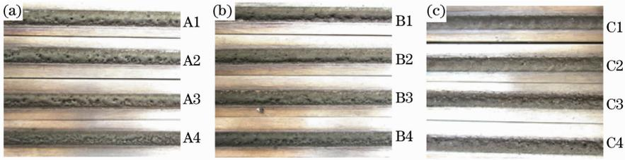
图 2 不同成分配比下复合涂层的表面宏观形貌。(a) A1~A4 样品;(b) B1~B4 样品;(c) C1~C4 样品
