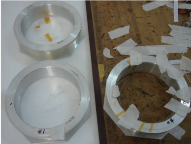
图 5 3 只直径相同保偏光纤环
