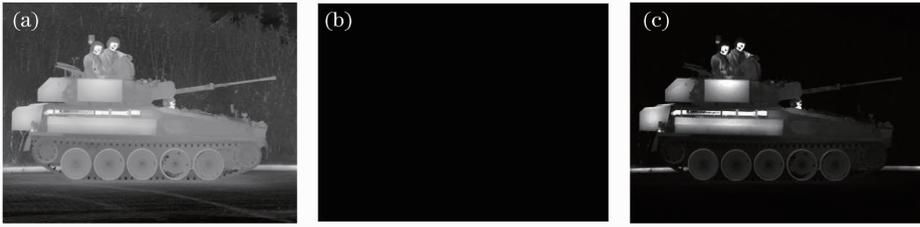
图2 实拍图像及紫外仿真。(a) 8~12  $\mu\text{m}$ ; (b) 初始紫外仿真; (c) 增强紫外仿真
