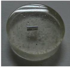
图 4 CCD 经过镶样、打磨和抛光处理之后的样品图
