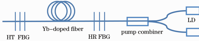
图 2 光纤激光器的实际结构
