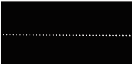
图 7 ASE 光源下的 AWG 输出波分光信号
