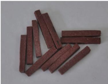
图 1 底排推进剂实验样品
